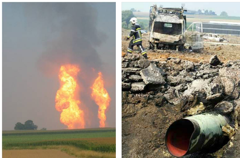
Figure 3 : Vues du feu torche et de la canalisation rompue, accident sur une canalisation de transport de gaz naturel à Ghislenghien (Belgique) le 30 juillet 2004. (source : www.aria.developpement-durable.gouv.fr )
