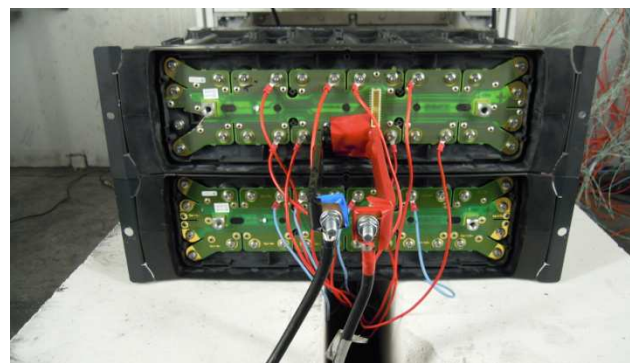
Caractérisation d'une batterie usagée en vue de son orientation déchet/seconde vie
