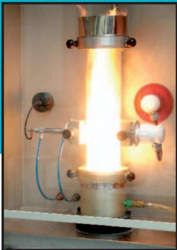
Mesure de l'énergie minimale d'inflammation d'un nuage de poussières.
