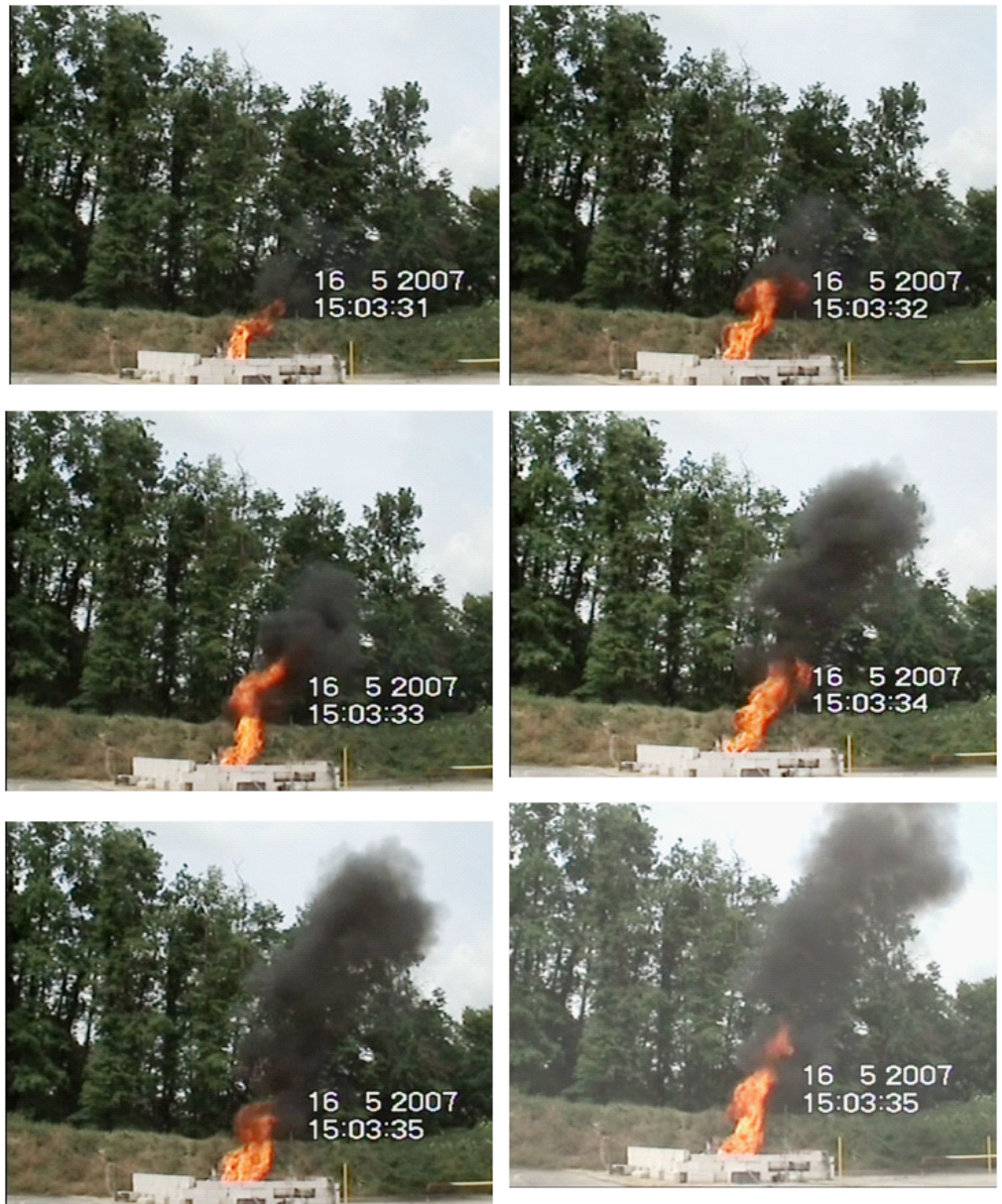
Figure 6: séquence d'images relative à la recherche de projections avec le brut léger
