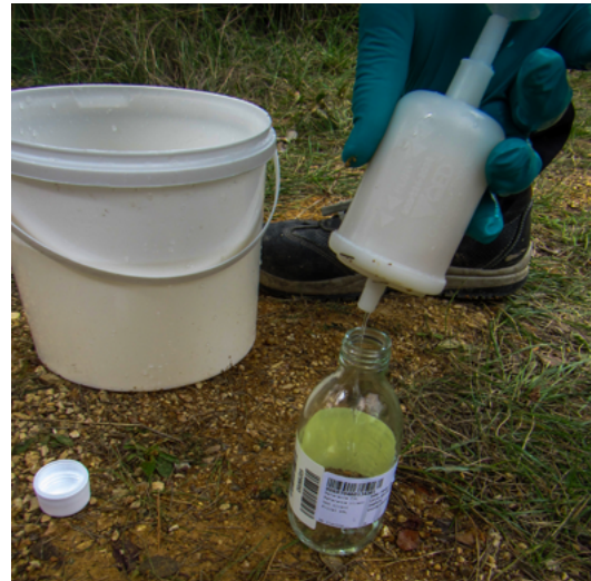
Figure 4 / Filtration sur site
