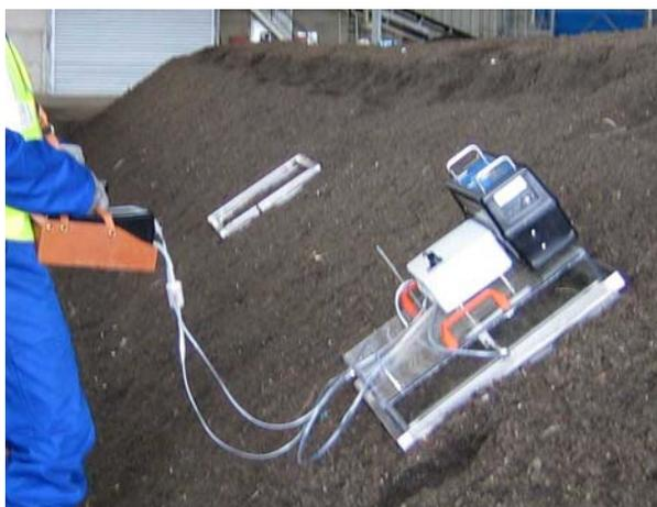
Au deuxième plan, on voit une deuxième embase posée, prête à recevoir la chambre. Chaque mesure dure ainsi moins de 5 minutes.
