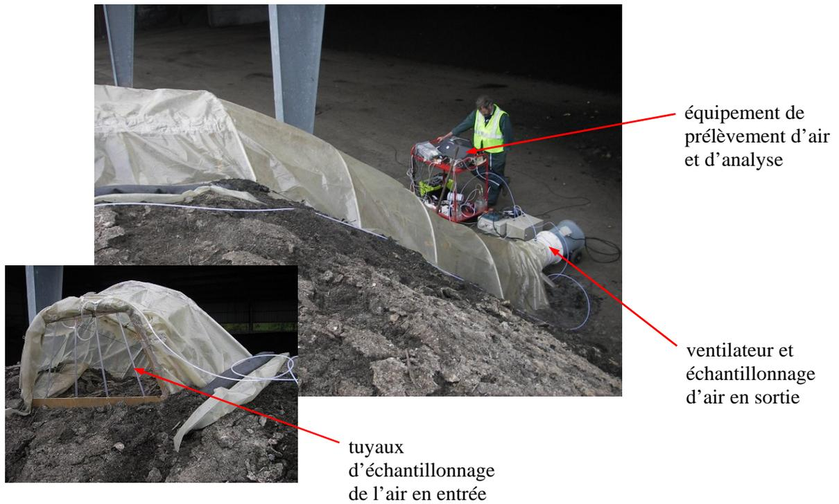
Figure 17 : Tunnel ventilé (grand modèle) en fonctionnement sur le site B
