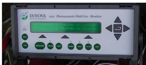
Avec 5 gaz analysés, c'est-à-dire sans SF<sub>6</sub>, la durée d'analyse est d'un peu moins d'une minute. Un point faible de l'analyse photo-acoustique est les interférences entre gaz, même si ces effets sont censés être compensés par l'appareil. De ce fait, les sensibilités théoriques indiquées dans le tableau ci-après sont vraisemblablement optimistes.
