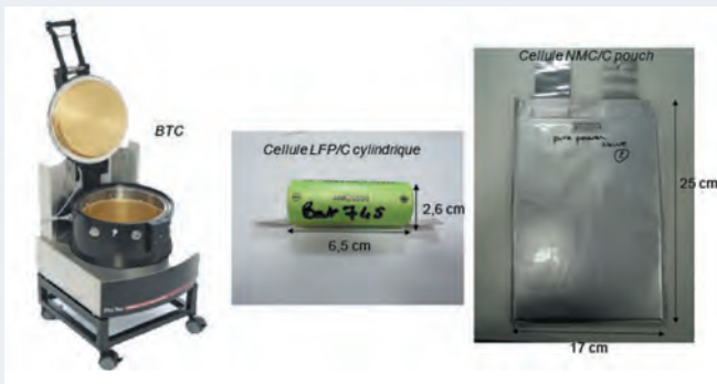
Fig1 Battery testing calorimeter (BTC) et exemple de deux types de cellules testées dans le BTC
