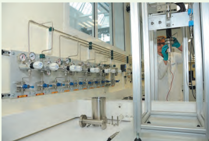
Fig1 : Préparation d'un essai pour établir l'isotherme d'adsorption d'un gaz sur une roche par méthode gravimétrique.
