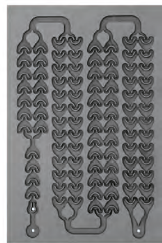
Figure 2 Vue d'une plaque en carbure de silicium avec son canal réactionnel.
