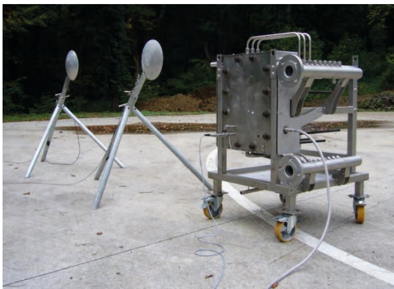
Figure 3 Installation expérimentale (capteurs de pression atmosphériques et capteur de pression sur plaque SiC, caméras non visibles sur l'image).
