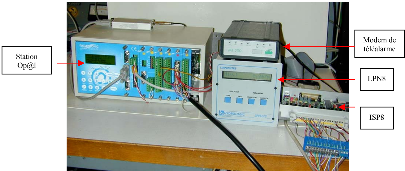
Photo 12 : Test mis en œuvre : capteur LPN8 raccordé à une station Op@l via interface ISP8
