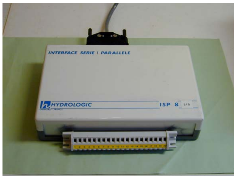
Photo 11 : Interface ISP8 raccordé au capteur LPN8
