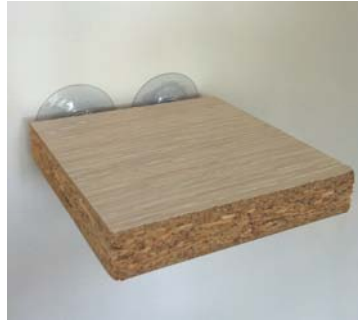
Figure 9 : Plaque développée par l'INERIS pour échantillonner les poussières « fraîches »
