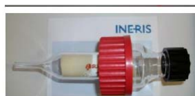
Figure 5 : Cartouche PUF/XAD2/PUF avec adaptation INERIS pour connexion au Microvol
