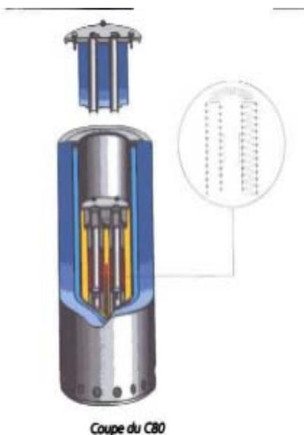
Le C 80 est un calorimètre isotherme qui a la possibilité de fonctionner soit par mélange de débits soit en discontinu. Le flux thermique dégagé ou absorbé par le mélange des réactifs est dissipé à travers un assemblage de thermocouples constituant un fluxmètre vers une masse métallique constituant un puits thermique.
