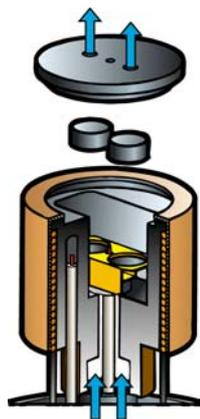
La figure présentée ci-contre représente schématiquement le fonctionnement d'un appareil d'analyse thermique tel que l'ATD ou la DSC. Le principe de ces appareils est la mesure par flux de chaleur.
