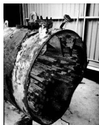
Figure 2 : Élément de chaudière projeté par effet fusée
