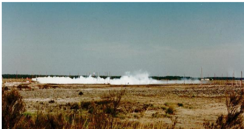
Figure 13 : Photographie d'un rejet continu d'ammoniac [15] (Crédit Ineris)
