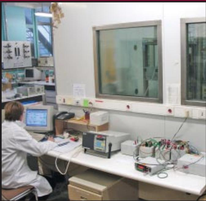
**Essai de sensibilité d'analyseurs d'ozone à des interférents chimiques.**
