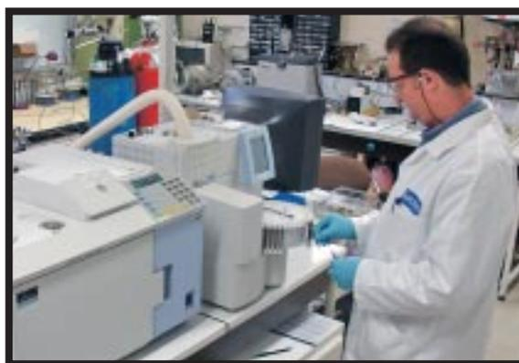
**Analyse de COV par désorption et chromatographie en phase gazeuse.**
