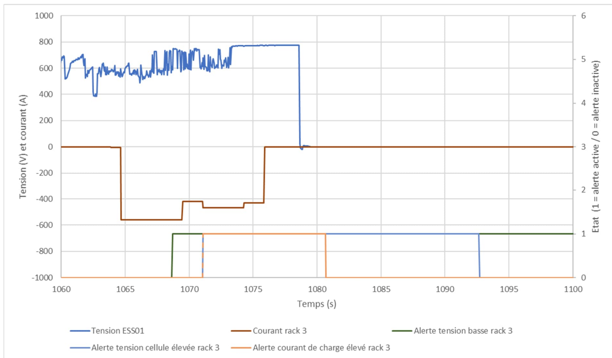
Figure 25: Alerts relevées sur les mesures électriques dans le rack n°3
