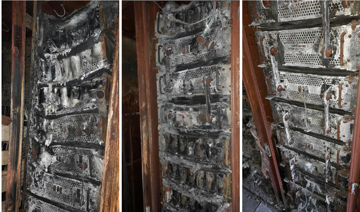
Figure 27: Racks supercondensateurs, du plus proche (gauche) au plus éloigné (droite) de la porte du container
