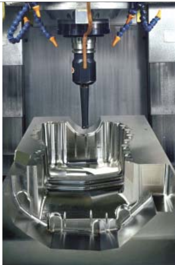
USINAGE d'un moule pour une machine-outil.
