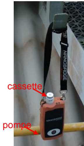
Figure 5 : Préleveur portatif Nanobadge.
