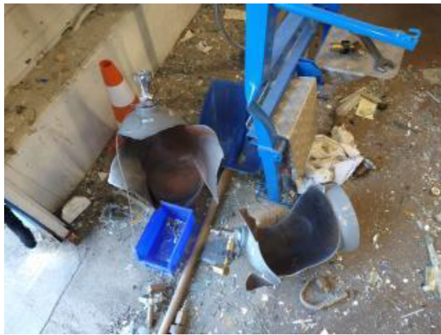
Figure 4 : Deux bouteilles éclatées
