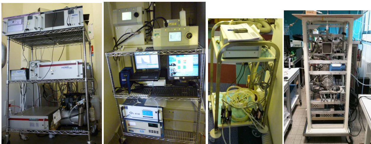
Figure 4 : Instrumentation de l'étage de MARLA (analyseurs C2-C6, C6-C12, ozone, oxydes d'azote, SMPS, système de prélèvements pour Tenax TA et DNPH).
