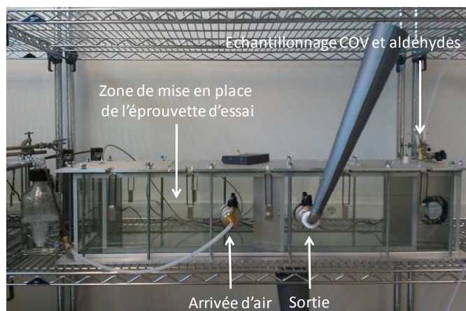
Figure 2 : Chambre d'essai d'émission (CSTB)
