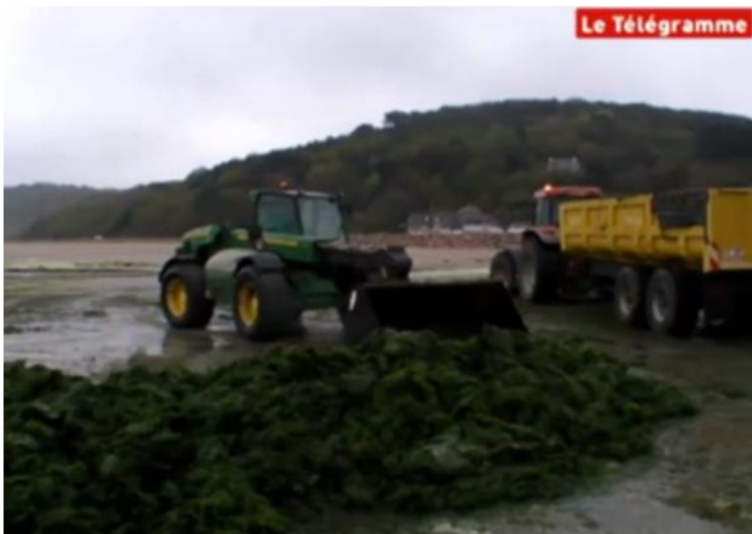
Photo 8 : Ramassage à St Michel en Grève : chargeurs télescopiques + bennes agricoles de 24 tonnes
