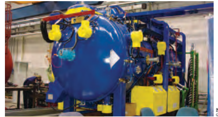
Le four de brasage sous vide et sans atmosphère contrôlée du pôle brasage à l'EEIGM.
