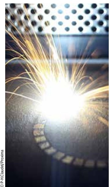
↑ Fabrication additive - fusion d'une couche de poudre par laser.
