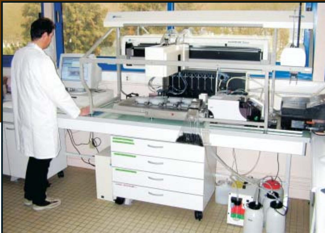
**Automate pour les mesures de paramètres biochimiques.**
