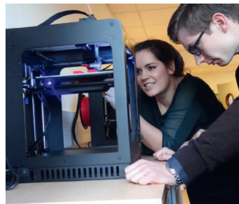
↑ L'une des machines de fabrication additive installée dans le Laboratoire d'innovation de SUPii Mécavenir.
