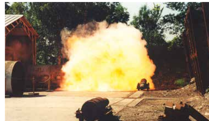
↑ Explosion de 5 kg de farine de blé mise en suspension.
