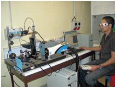
Système de génération de plasma par laser pour la détection de nanoparticules dans l'air.
