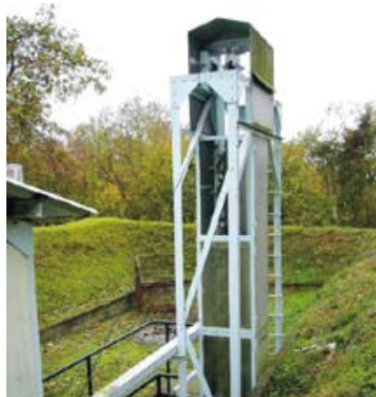
Installation pour essai de chute et de choc sur les stockages d'énergie électrochimique.
