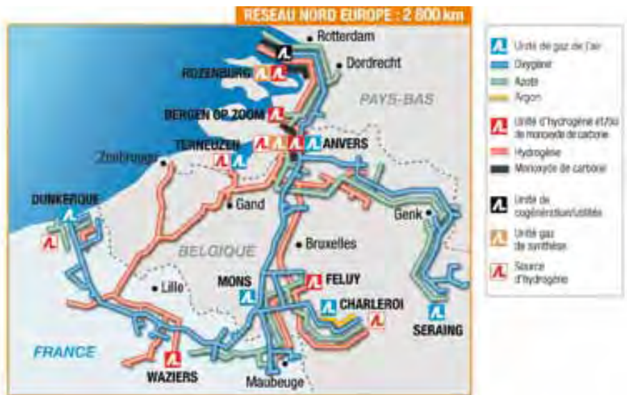
Réseau de gazoducs d'Air Liquide®
