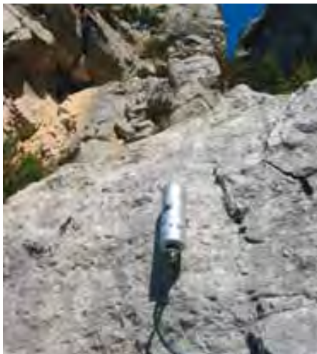
Géophone enregistrant l'activité microsismique de la roche
