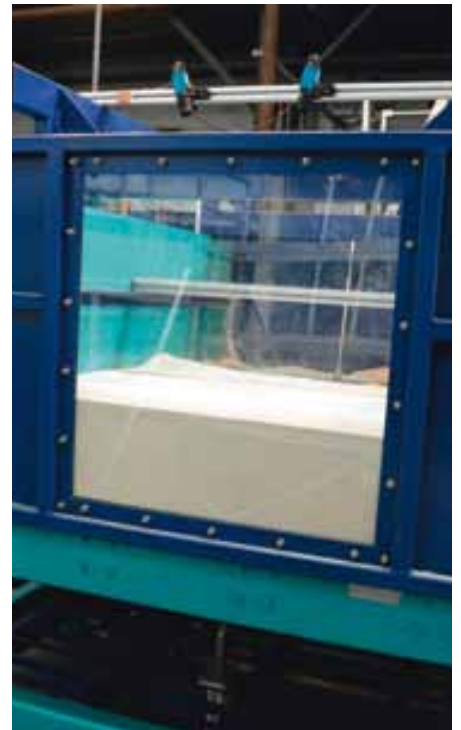
Modèle réduit pour l'étude de l'interaction sol-structure
