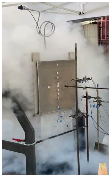
Figure 1 : Rejet cryogénique impactant une plaque instrumentée en température
