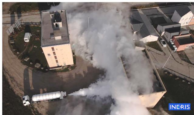
**Figure 1 : Rejet de CO<sub>2</sub> impactant un bâtiment grande hauteur durant les essais Cenzub**
