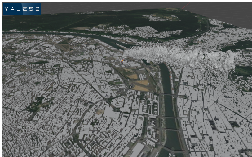
Simulation Haute-Fidélité de l'incendie Lubrizol Normandie Logistique avec la plateforme YALES2
